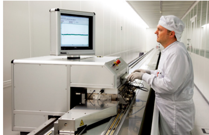
長さ30 mのスケールテープ測定装置
