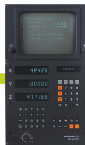
1981: TNC 145, 海德汉公司的第一代轮廓加工数控系统
