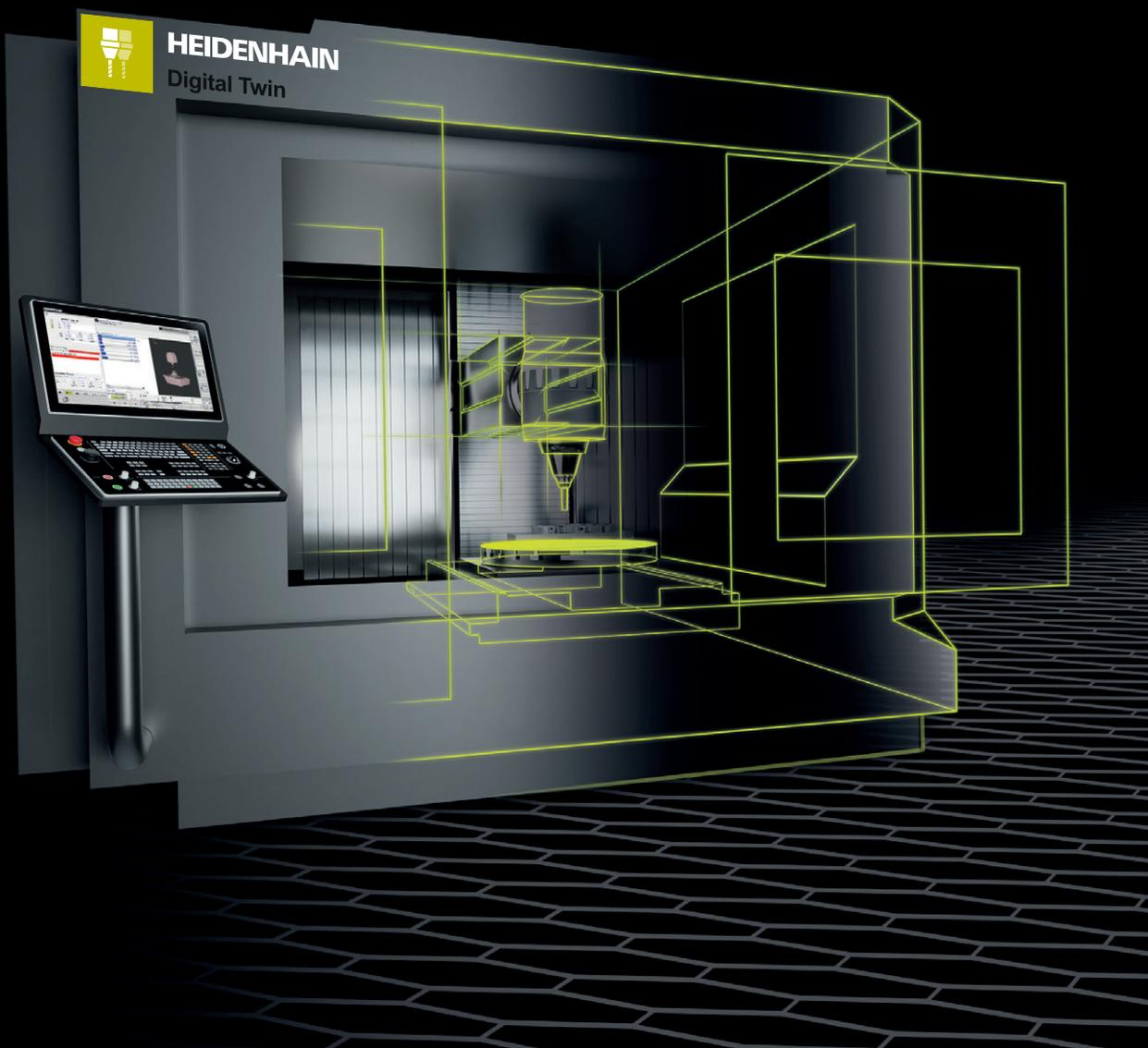
Il Digital Twin è la riproduzione realistica della macchina sulla stazione di programmazione per disporre in fase di progettazione e programmazione in ufficio di cinematiche effettive, parametri e funzioni della macchina disponibili in officina. E per avere la sicurezza che i programmi creati sul sistema CAM o sulla stazione di programmazione possono essere eseguiti senza intoppi.
